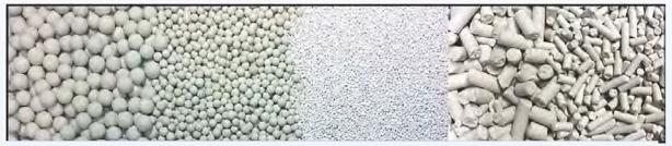
4x8 mesh | 8x12 mesh | 20x40 mesh | 1/8 Inch | 1/16 Inch Type 3A Molecular Sieve
